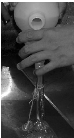
写真1 メスフラスコ内に洗浄液を満たす。
