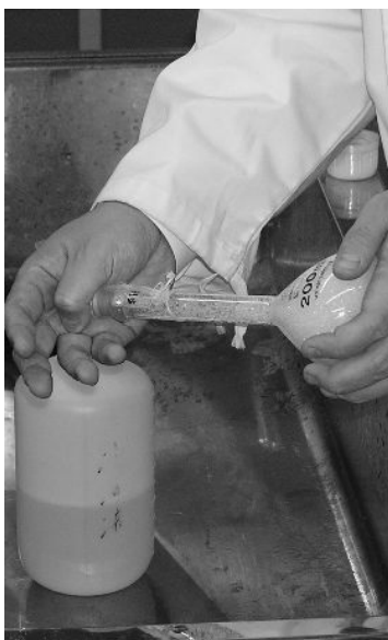
写真2 両手でメスフラスコの上下をしっかりと握り激しく攪拌する。
