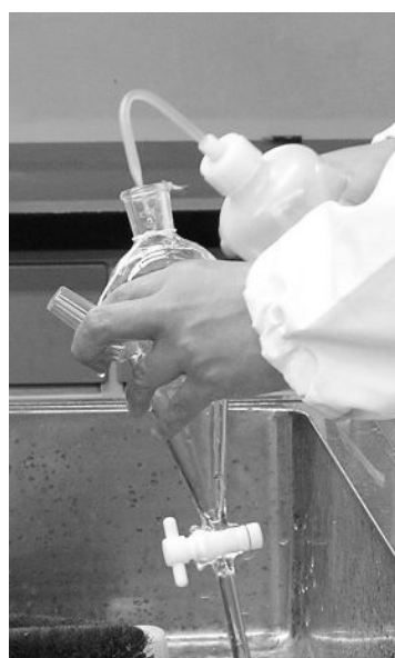
写真4 洗ピンで内部外部とも十分に すすぐ。
