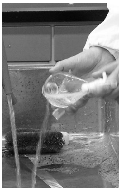
写真3 洗浄液を戻した後、水道水で 泡がなくなるまで十分にすすぐ。
