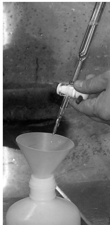
写真2 洗浄液を数分後に排水する。
